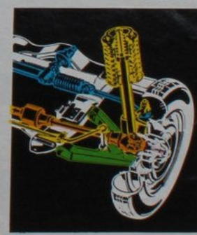
Détails de la suspension avant et de la suspension arrière. Dans les deux cas, on retrouve des ressorts hélicoïdaux placés très hauts, avec amortisseurs hydrauliques télescopiques incorporés.
