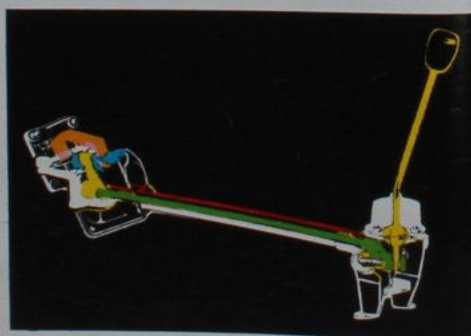
Tandis que la berline 304 dispose d'un levier sous le volant, les cabriolet et coupé reçoivent une commande de boîte placée au plancher.
